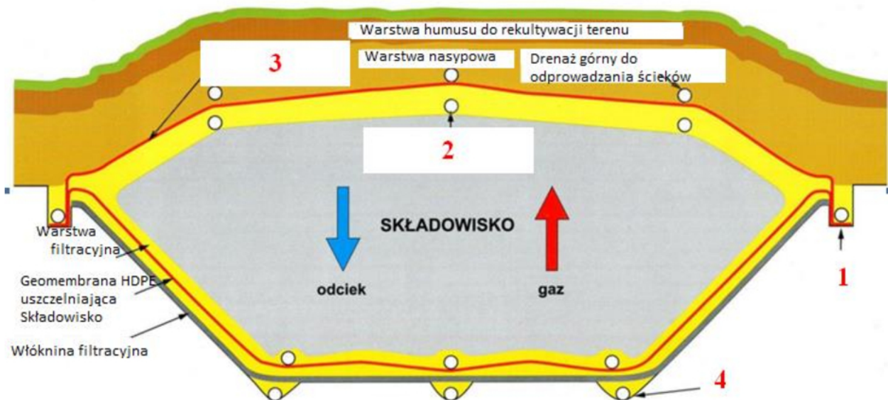
Przekrój składowiska odpadów
