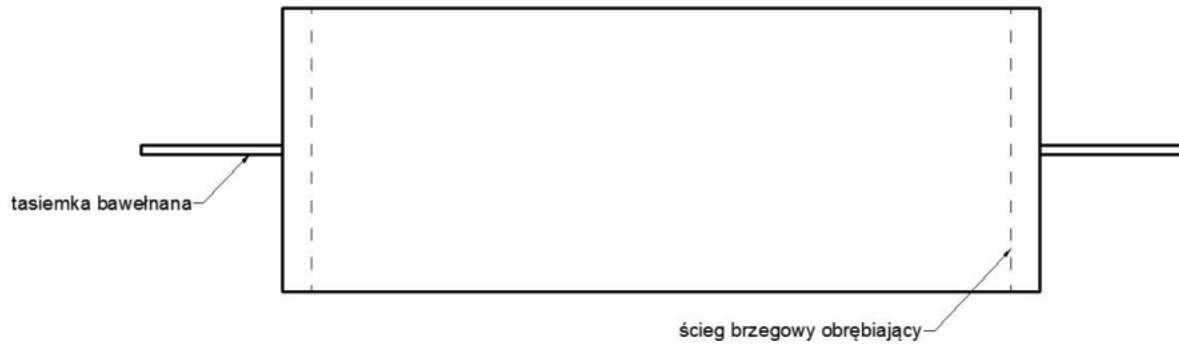
Rysunek 1. Sposób przeszycia krótkich boków poszewki, z wszyciem tasiemek bawełnianych służących do zamykania poszewki.
