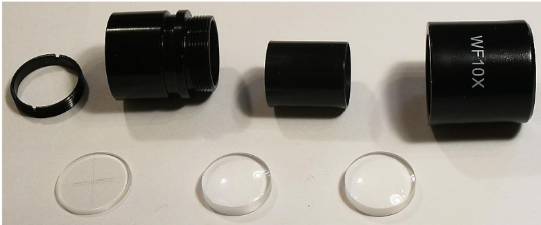
Rysunek 2. Zespół okularu mikroskopowego w rozbiorze na części.
