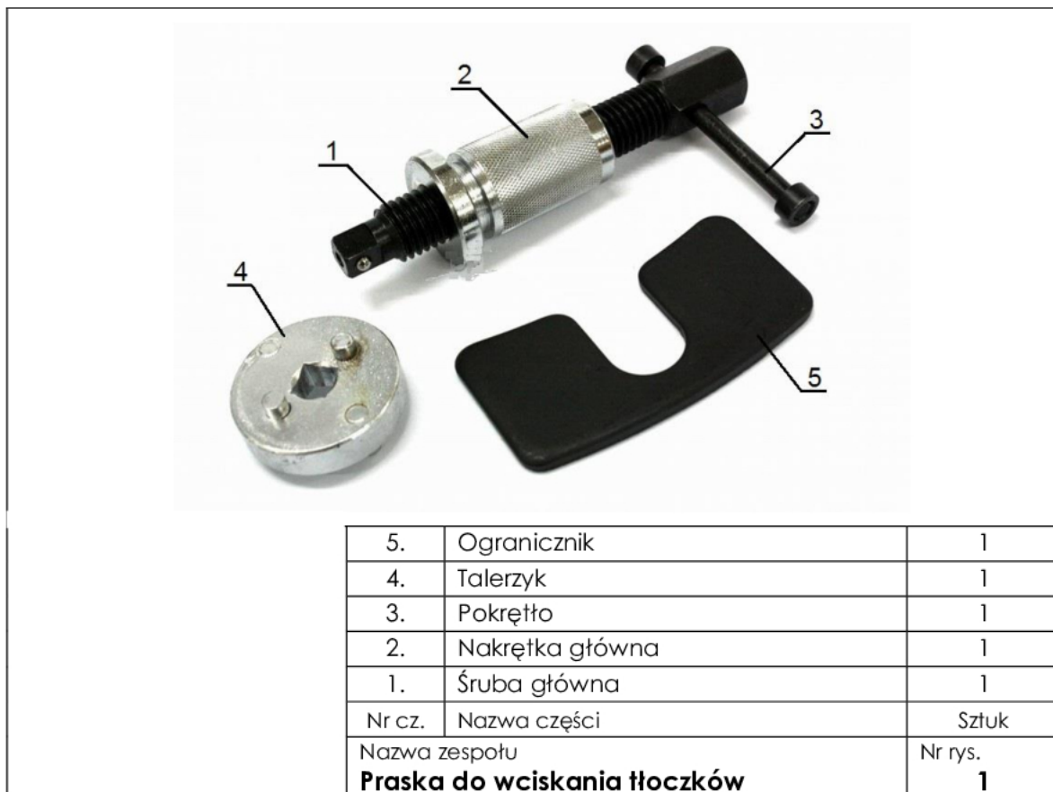
Rysunek 1. Praska do wciskania tłoczków
