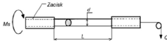
Schemat próby jednokierunkowego skręcania drutu
