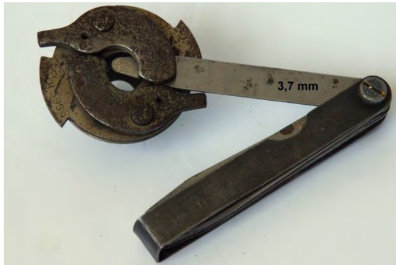
Rysunek 5. Pomiar luzu dla zapadek sprzęgła impulsowego
