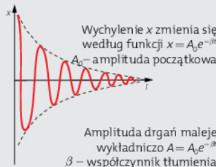
Zależność wychylenia od czasu w ruchu harmonicznym tłumionym przy niewielkim tłumieniu.
