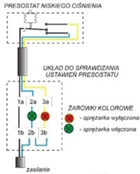
Rysunek 3. Schemat podłączenia układu do testowania presostatu.
