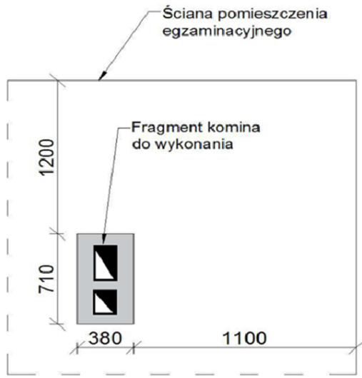
Rysunek 1. Usytuowanie fragmentu komina na stanowisku egzaminacyjnym
