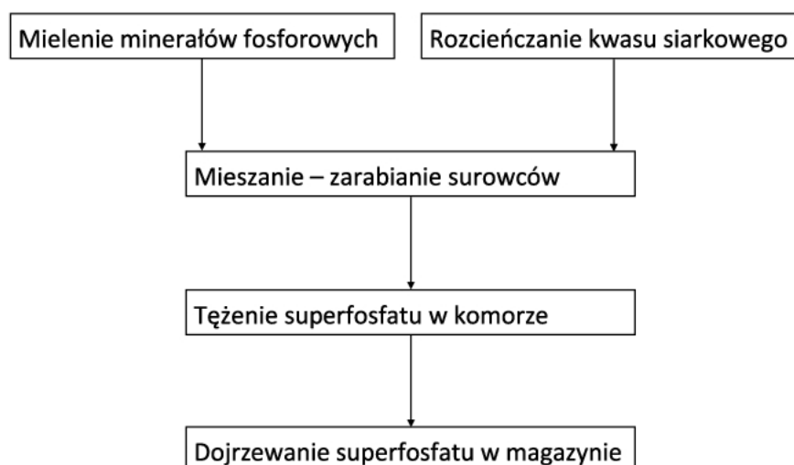
Rysunek 1. Schemat ideowy produkcji superfosfatu prostego
